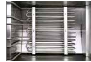
Résistance, brides et cache-filtrant / Heating element, flanges and filtering cover
